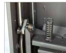
Mehanizem »easy-lift« omogoča lažje odpiranje dvizhnih vrat
